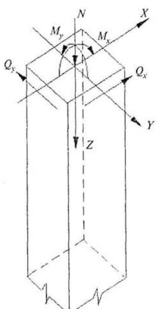
Рисунок 8.1 — Схема усилий, действующих на выделенный стержневой элемент
