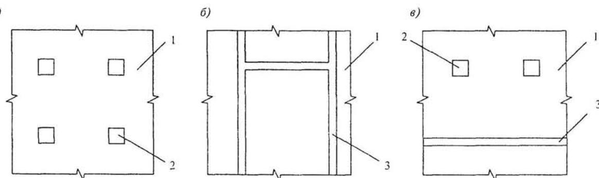
*a — колонная КС; б — стенная КС; в — смешанная КС;*
